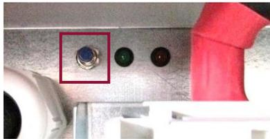
3. Sicherungshalter ziehen und aus dem Trenner entfernen.
