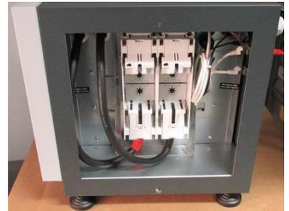
4. Kabelbinder vom USB-Kabel entfernen und internen USB-Stecker aus der Rückwand ziehen.
