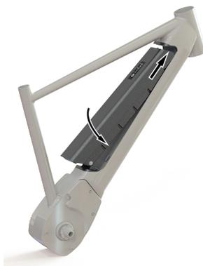
Das Brose e-Bike System ist mit einer Vielzahl verschiedener Akkuvarianten kombinierbar. Montage und Demontage des Akkupacks sind abhängig vom verwendeten Akku-Modell. Detaillierte Informationen hierzu erhalten Sie von Ihrem Fahrradhändler und Fahrradhersteller.
